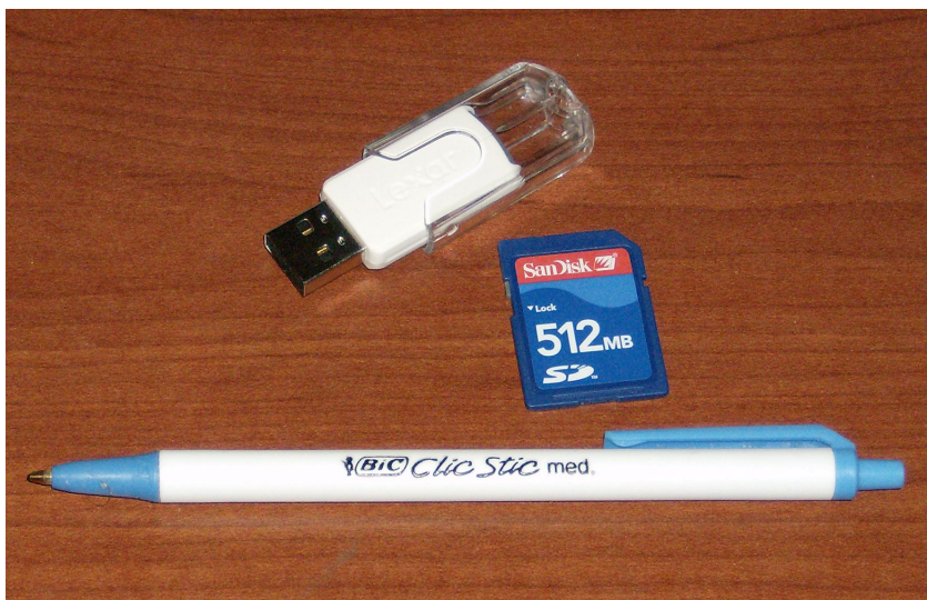
5 pav. Nekeičiamosios kietosios atminties įrenginiai. Lexar 2 GB atmintinė (kairėje) ir SanDisk 512 MB Secure Digital Card (dešinėje). Rašiklis padėtas, kad būtų galima geriau įsivaizduoti mastelį.
