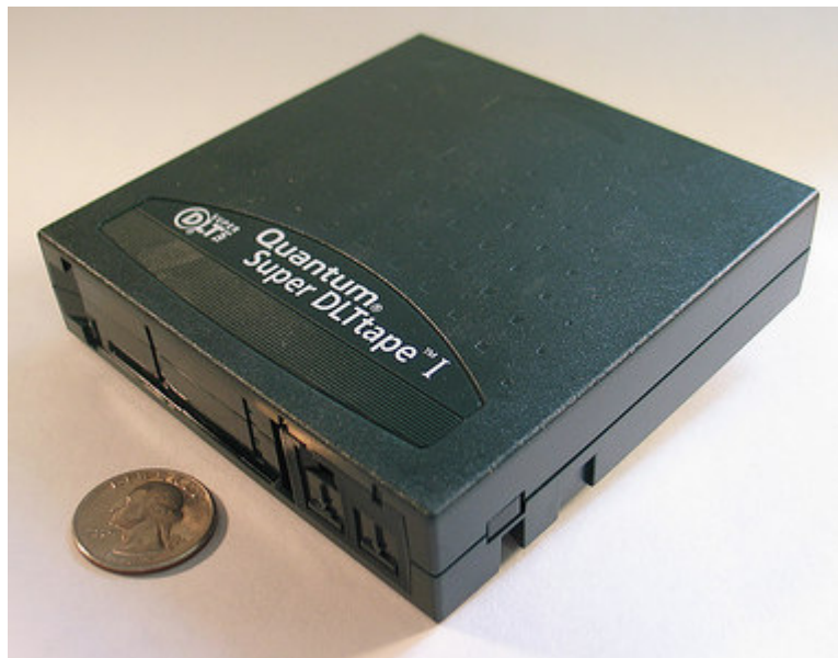
13 pav. SuperDLT juostinė kasetė. Nuotrauka: redjar. Pagal Creative Commons Attribution-Share Alike 2.0 Generic licenciją
