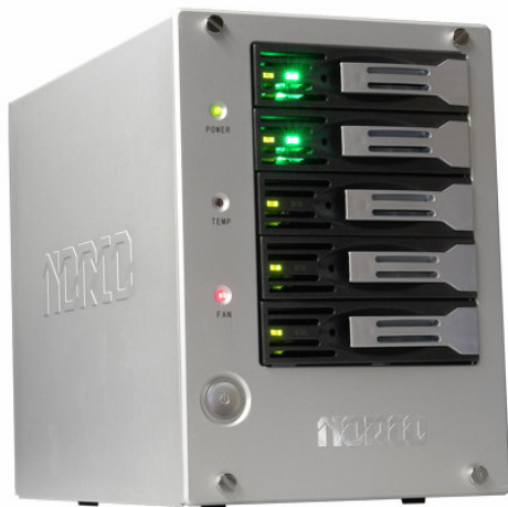
9 pav. Norco Technologies DS-500 5-Bay keičiamas SATA RAID saugojimo masyvas su rezerviniu disku. Atkreipkite dėmesį į svirtis kiekvieno disko priekinėje pusėje, leidžiančias greitai išminti bet kurį diską (šaltinis: http://www.norcotek.com/item_detail.php?categoryid=8&modelno=ds-500 )
