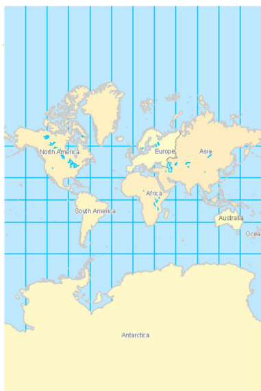
Lygiakampė normalioji Merkatoriaus projekcija (cilindrinė pagal tinklelio formą) Grenlandija atrodo didesnė už Australiją
