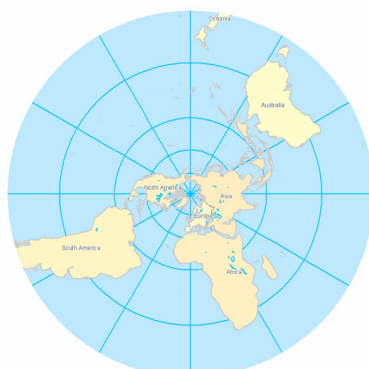
Stereografinė plokštuminė projekcija – projektavimo centras yra gaublio taške, priešingame plokštumos lietimosi taškui
