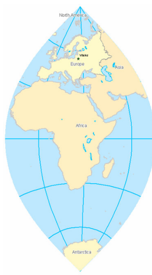
Lygiakampė skersinė Merkatoriaus projekcija (cilindrinė pagal tinklelio formą, skersinė pagal išklojamo paviršiaus orientaciją)
