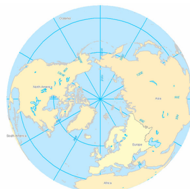
Ortografinė plokštuminė projekcija – projektavimo centras yra begalybėje
