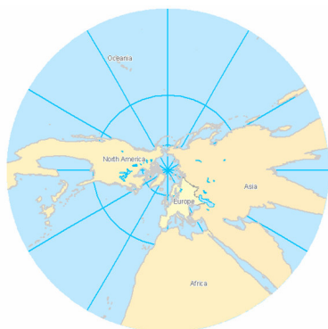
Gnomoninė plokštuminė projekcija – projektavimo centras yra gaublio centre
