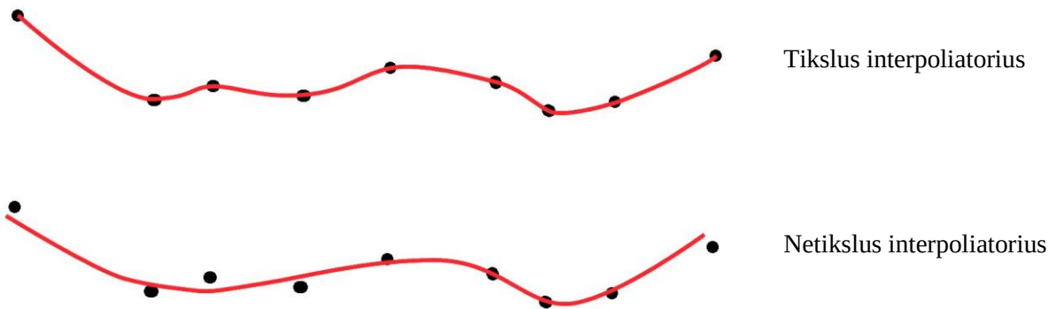
5.8 pav. SAM profiliai, sukurti, naudojant tikslus interpoliatorius (viršuje) ir netikslus interpoliatorius (apačioje). Atkreipkite dėmesį, kad interpoliatoriai nepanaudoja visų taškų, tačiau reljefo ypatybės išreiškiamos geriau.
