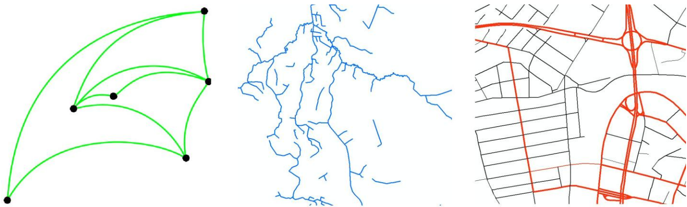
3.4 pav. Trijų galimų tinklo tipų, kuriems naudojamos tiesios linijos, išsišakančios linijos arba trasos, pavyzdžiai: oro linijų maršrutai (kairėje), upės (centre) ir kelių tinklai (dešinėje).
