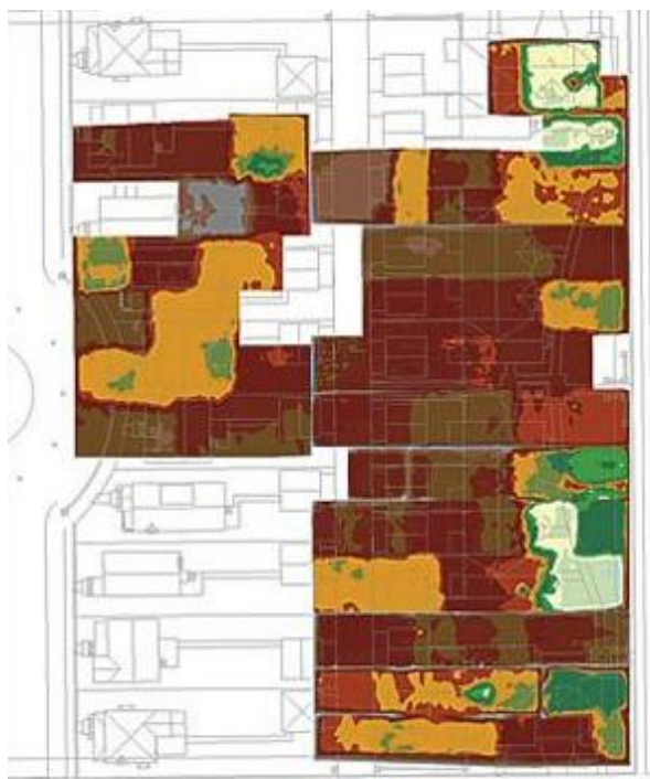
5.29 pav. Pašalintos ir papildytos medžiagos analizėje parodyti reikalingos iškasti Milvaukyje (Viskonsinas, JAV) žemės gylis (Misky et al., 2004).
