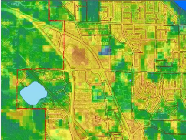
4.15 pav. Kalibruotas Landsat 7 šiluminės juostos vaizdas: raudonos gardelės vaizduoja šiltesnes vietas, žalios – šaltesnes
