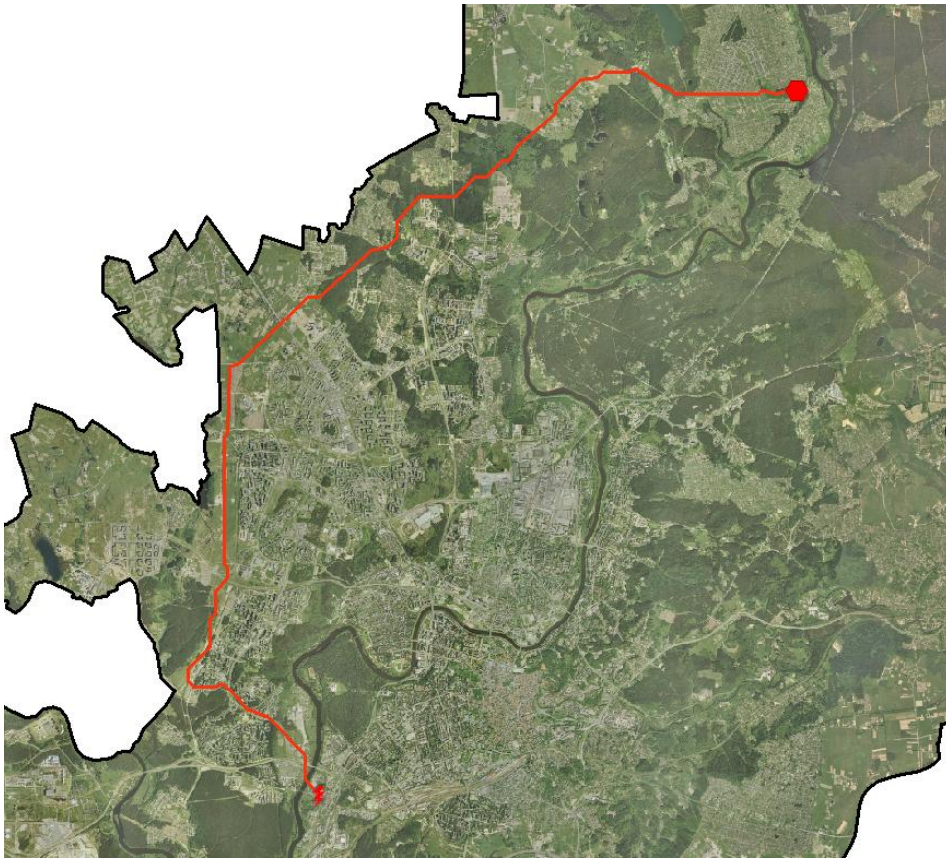
22 pav. Elektros linijos mažiausių sąnaudų trasa, užklota ant Vilniaus ortofotografinio žemėlapiu. Atkreipkite dėmesį, kad trasa neina per centrinius Vilniaus rajonus.
