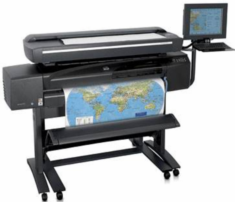
8 pav. Hewlett-Packard 820mfp skeneris–braižytuvas. Šaltinis:
