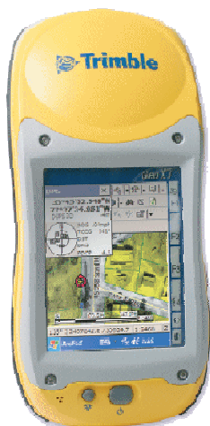
7 pav. Trimble GeoXT duomenų rinkimo kompiuteris su GPS funkcija. Šaltinis:
